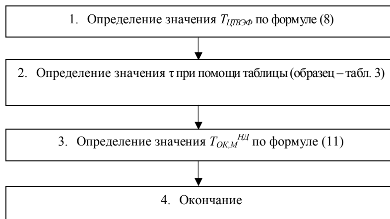
Рисунок 1 - Укрупненная блок-схема алгоритма определения T_{OK,M}^{HD} (рассматривается совместно с табл. 3)
