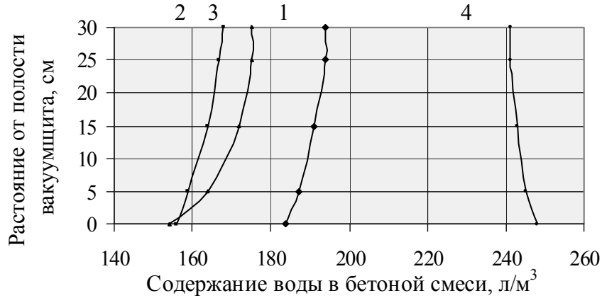
Рисунок 1- Водосодержание свежеобработанного фибробетона, соответственно при: 1 – 0.06 МПа; 2 – 0.075 МПа; 3 – 0.09 МПа и 4 – необработанного вакуумом фибробетона.
