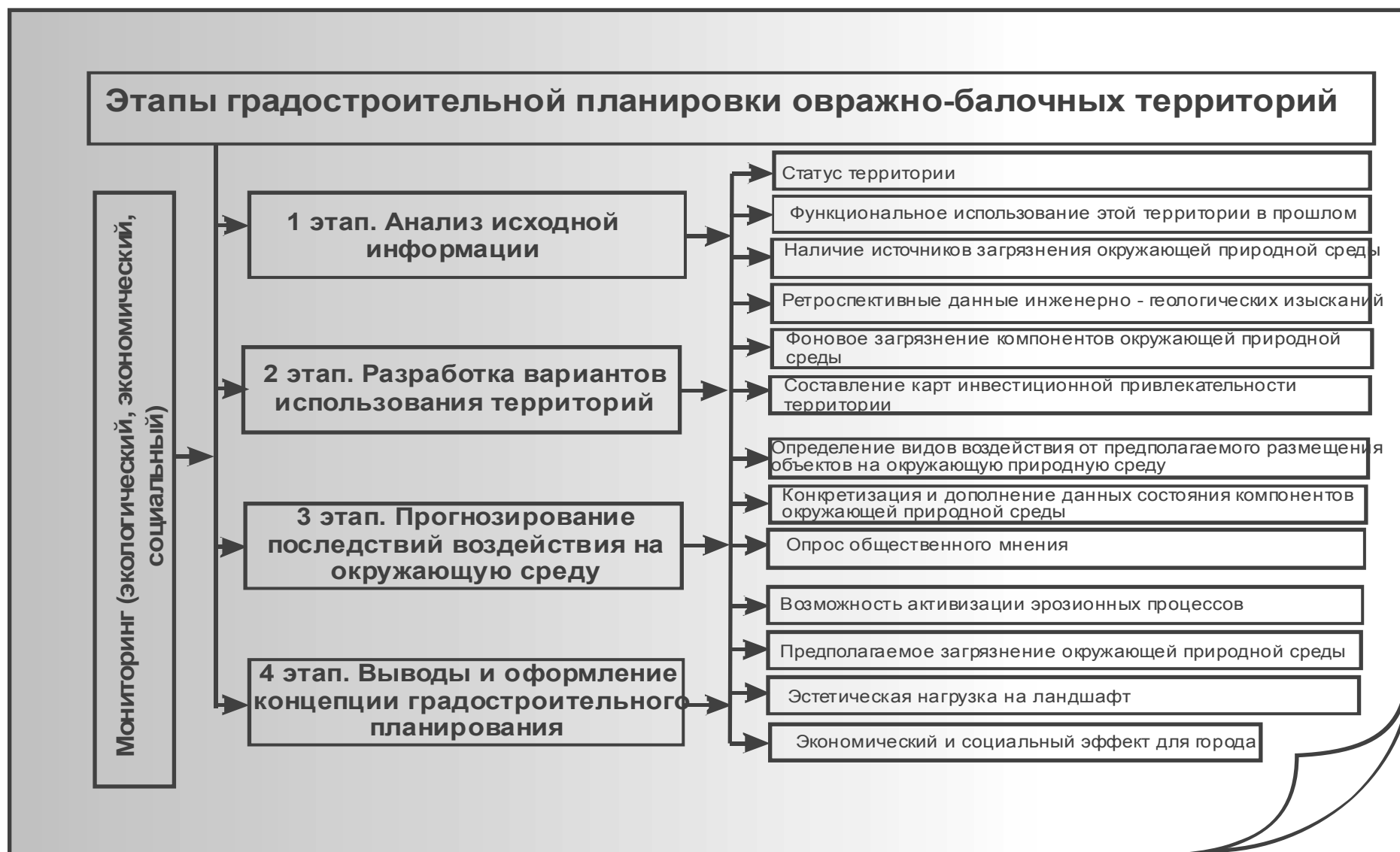
Рисунок 2 – Схема этапов градостроительной планировки овражно – балочных территорий
